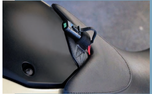
Via een 12V-minilaadkabel kunt u heel eenvoudig de status van uw accu aflezen en de accu opladen.
