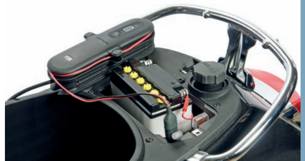
Zo werkt het. We raden u wel aan om de laadkabel te laten hangen zodat hij eenvoudig toegankelijk is. Zo hoeft u zich niet steeds een weg te banen naar de accu om hem op te laden.
